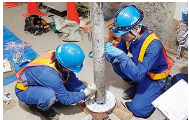
地下深くに埋めていた鉄製の円柱を取り出している状況。鉄の周りの粘土を取り除き（写真左）、錆びた鉄を採取する（写真右）
